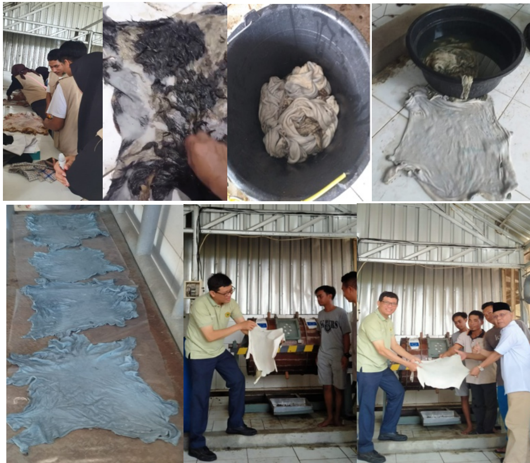
Gambar 4. Proses penyamakan kulit kambing
