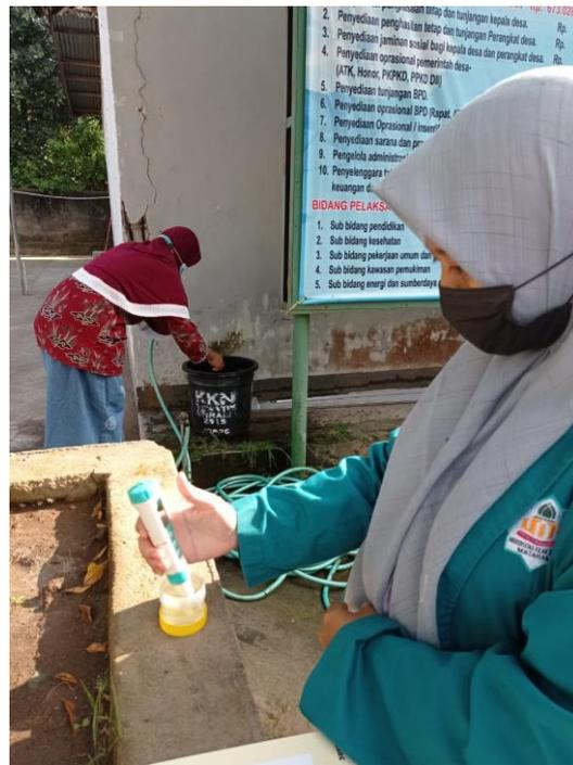
Gambar 3. Proses pengukuran tingkat kualitas air sumur warga Desa Telagawaru dengan menggunakan TDS meter
